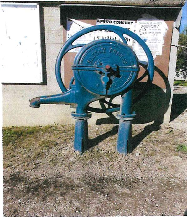
Le principe de fonctionnement de la pompe à chapelet est d'élever une colonne d'eau dans un tuyau, grâce à des tampons de caoutchouc de même diamètre que l'intérieur du tuyau. Ceux-ci sont entraînés par une chaîne qui est elle-même actionnée par une manivelle. La capacité d'une pompe à chapelet est fonction du diamètre de la gaine et de la vitesse de rotation de la chaîne. Le débit est de 4000 L / heure pour un tuyau de 40 mm de diamètre.
