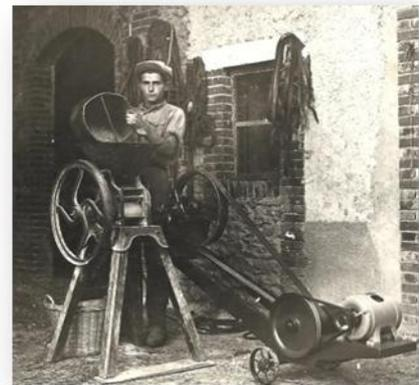
On le voit ici, photo de gauche, entraînant une meule à aiguiser les outils (faucheuse, moissonneuse-lieuse) et, photo de droite, un aplatisseur et écraseur à grain (ce matériel sert à aplatir le grain pour les animaux ou à l'écraser pour faire la farine d'orge des cochons).
